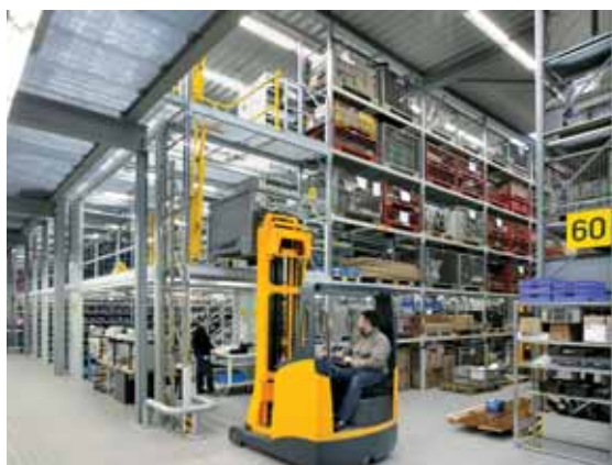
META CLIP® policový systém se systémem META MULTIPAL® na paletové regály a integrovaným předávacím místem pro paletu
