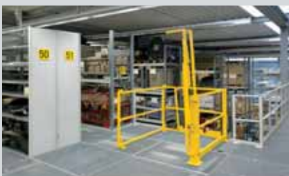
Otočné, zvedací zábradlí zajišťuje bezpečnost ve skladu
