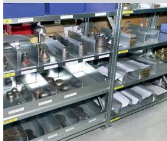
Vlevo: přihrádka na sypký materiál s přepážkami Vpravo: dělicí mřížky volně stojící
