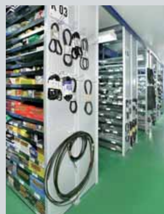
META CLIP® Euro děrované stěny s volně umístitelnými háčky, na které lze zavěsit různý materiál v různých pozicích
