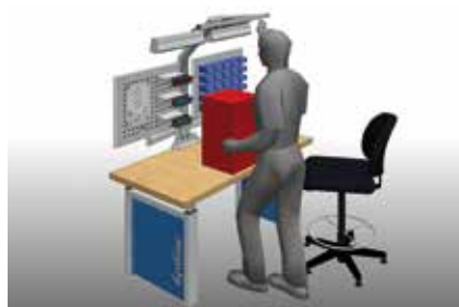
Stehend arbeiten, großes Werkstück und geringe Arbeitshöhe
